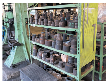
改善後の金型保管棚の例1
