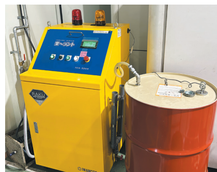
導入した切削機器の切削水処理の自動化装置
