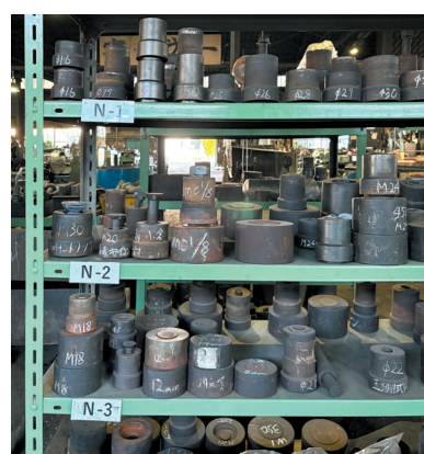
改善後の金型保管棚の例2
