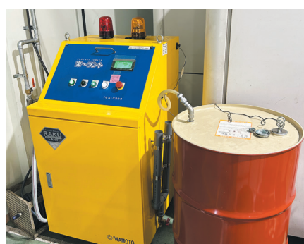
導入した切削機器の切削水処理の自動化装置
